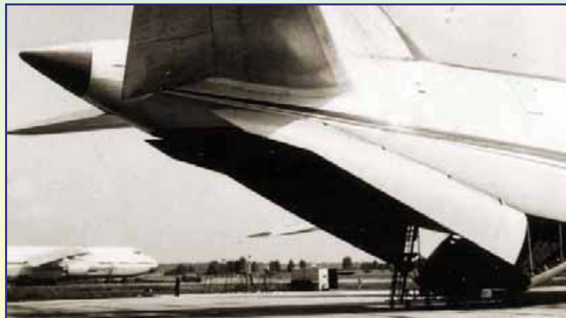
Cargo door panels of AN-124
